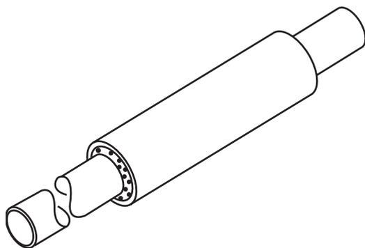
Abb. 809 Ansaugschalldämpfer
