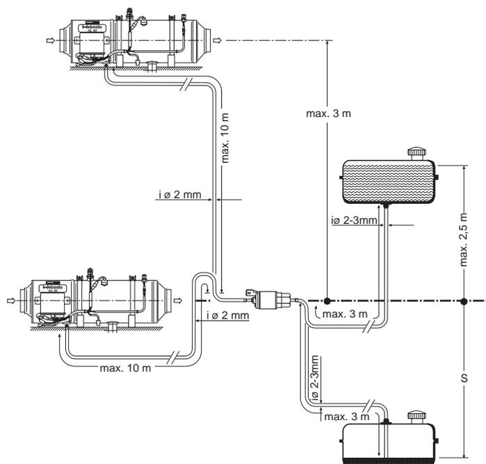
Abb. 802 Brennstoffversorgung
