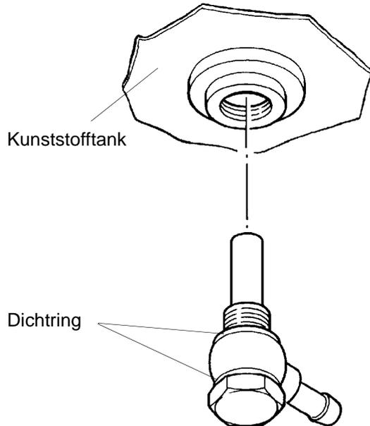
Abb. 804 Brennstoffentnahme aus dem Kunststofftank (Entnahme über Tankablassschraube)
