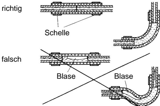
Abb. 806 Rohr/Schlauchverbindung
