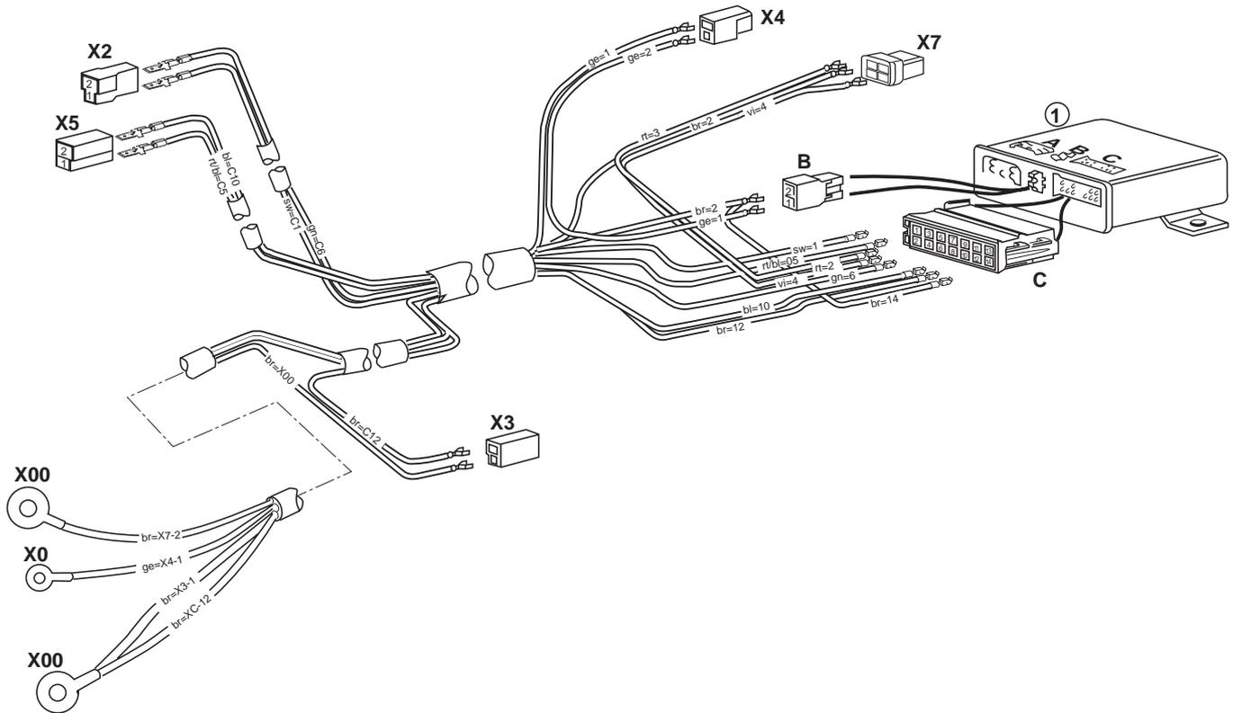
X2 Zwischensteckverbindung Dosierpumpe
