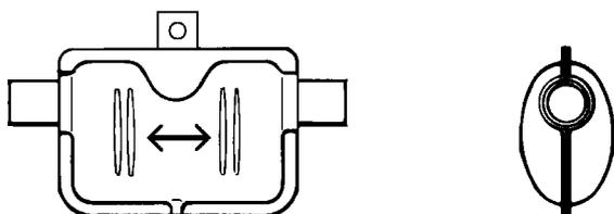
Abb. 810 Abgasschalldämpfer, Durchflussrichtung
