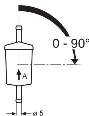
Abb. 808 Brennstofffilter
