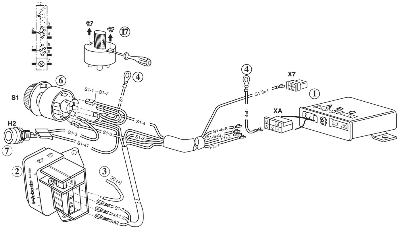
**Anschluss Steuergerät / Sicherungshalter / Schalter**
