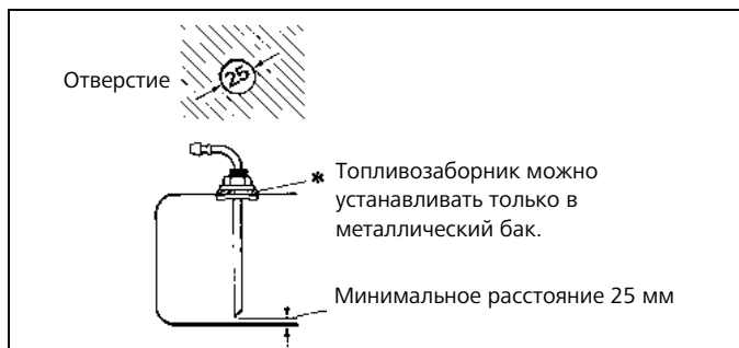
Рис. 9: Топливозаборник Webasto из бака
