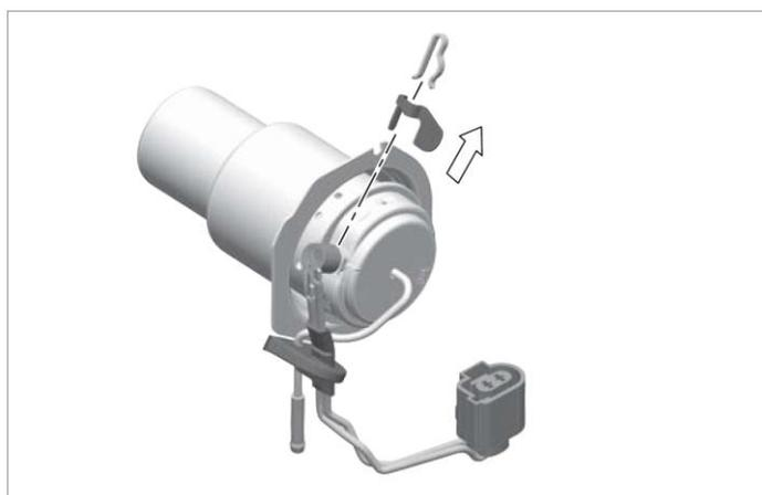
Рис. 9-7 Удалите охлаждающее ребро
