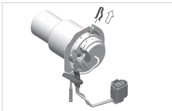
Рис. 9-6 Удалите пружинный держатель
